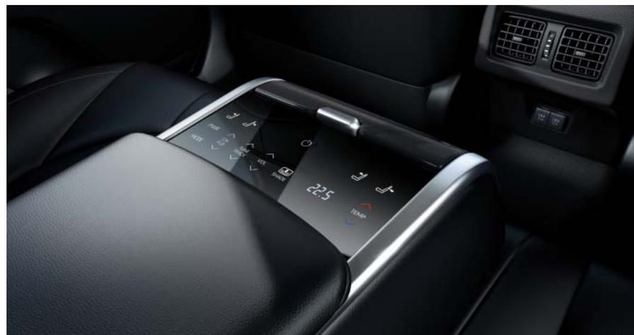
Une interface multifonctions installée dans l'accoudoir central permet aux passagers de la deuxième rangée de contrôler le système audio, le chauffage ainsi que la climatisation.
