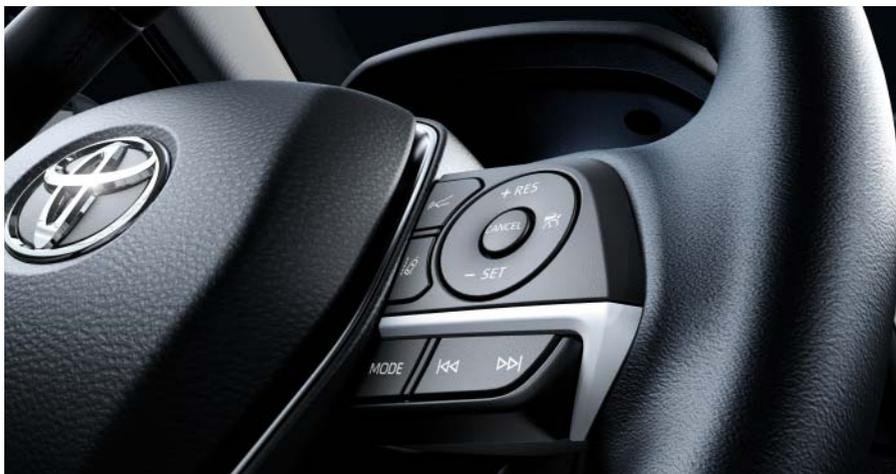
Les commandes du régulateur de vitesse sont intégrées au volant afin de pouvoir aisément modifier les réglages tout en conduisant.
