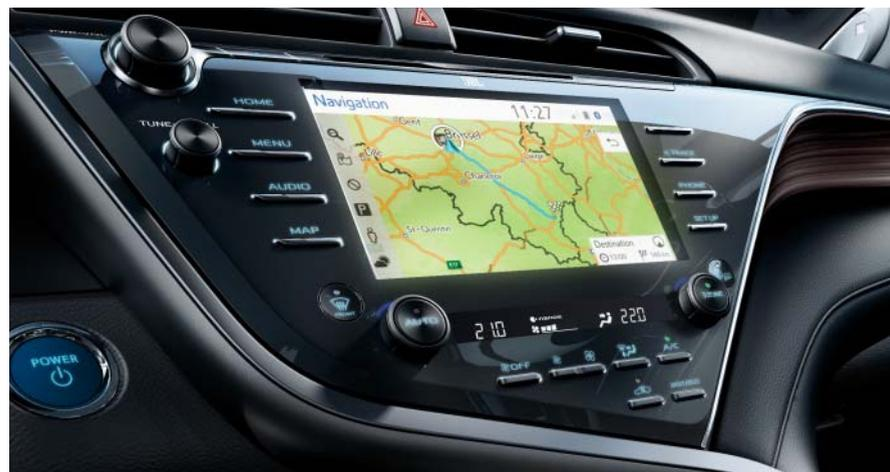
L'écran tactile 8" vous permet d'accéder aux paramètres du système audio, de la navigation et bien plus encore.
