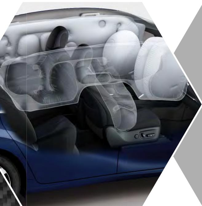
La sécurité est au centre de toutes nos préoccupations. Les réservoirs d'hydrogène (1) sont entourés d'une coque en polymères renforcés de fibres de carbone. Huit airbags (2) assurent la protection des passagers en cas de collision.
