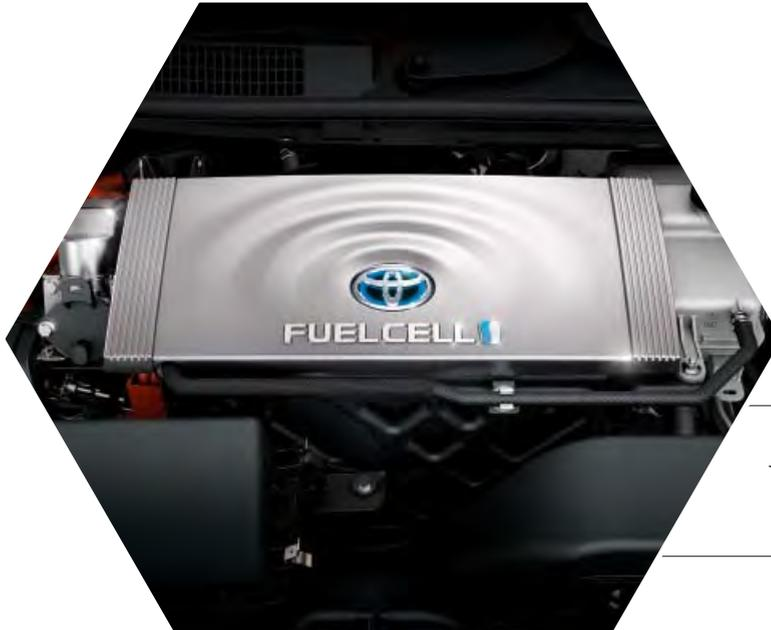
L'hydrogène stocké dans de solides réservoirs est acheminé jusqu'aux piles à combustible, où il réagit avec l'oxygène de l'air aspiré au travers de la calandre du véhicule. Cette réaction génère uniquement de l'énergie électrique et de l'eau, sans la moindre émission de CO<sub>2</sub> ou de tout autre polluant.
