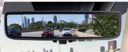
Le nouveau rétroviseur numérique fournit une meilleure vue d'ensemble de votre environnement. Sur simple pression d'une touche, le rétroviseur intérieur électrochromatique commute sur un moniteur haute définition affichant l'image en direct prise par une caméra placée en haut de la lunette arrière. Vous bénéficiez donc en permanence d'une vue optimale du trafic arrière, même si votre coffre est chargé jusqu'au toit.
